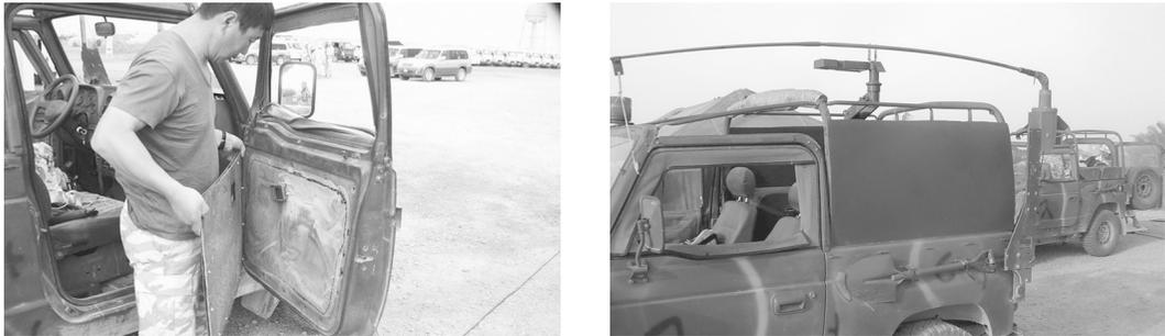
그림 15. 운전병/선탐자 방탄작업(좌)과 차량 측면에 5mm 철판장착(우)
