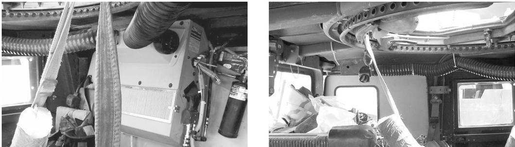
그림 10. 험비 내부에 설치된 에어컨(좌) 및 송풍호스(우)<sup>7)</sup>
