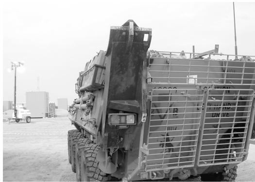
그림 3. LAV에 장착된 봉상형 장갑(SLAT장갑 원리와 동일)<sup>2)</sup>
