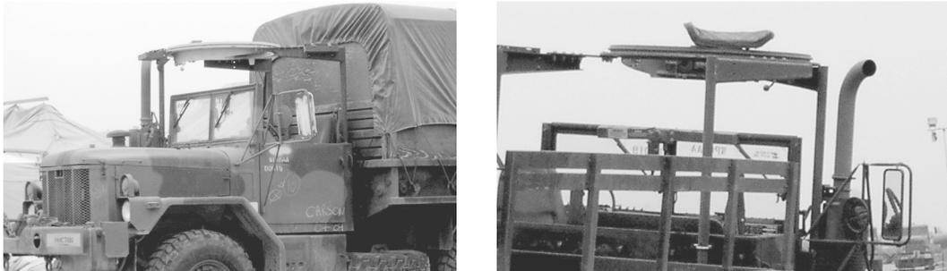
그림 11. 2½톤 및 5톤 선탑좌석 상판에 전방향 사격가능토록 설치된 거치대<sup>8)</sup>
